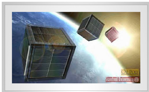
Figura 5: CubeSats son pequeños satélites utilizados para estudiar el clima espacial y los cambios atmosféricos (Adaptado de http://www.nsf.gov/news/news_summ.jsp?cntn_id=112341 )
