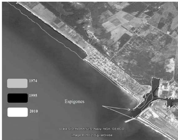
Figura 3. Espigones construidos en los 70's. Se presentan los cambios en la línea de costa a ambos extremos de las escolleras construidas, que separan las dos zonas de estudio.
