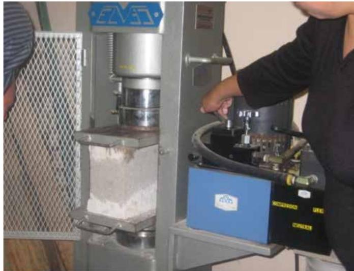
Imagen 14. Prueba de compresión. Fuente: Elaboración propia
