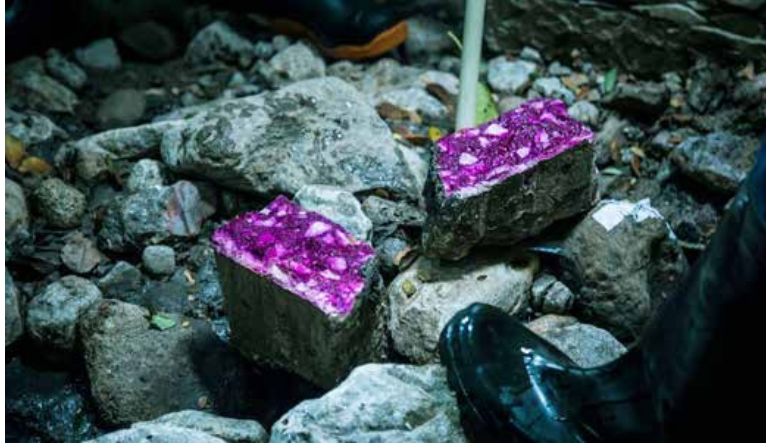
Figura 11. Medición de la Carbonatación en muestras de concreto de la losa in-situ , mediante una solución indicadora ácido-base: Fenolftaleína (Tavera, 2018)
