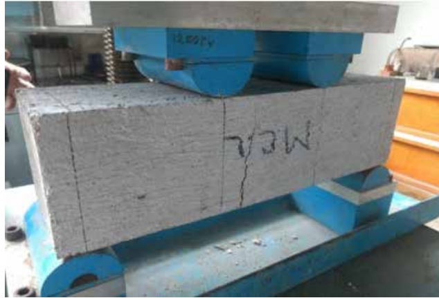
Figura 11. Ensayo de vigas a flexión. Fuente: Elaboración Propia
