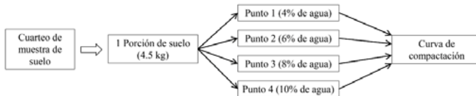
Figura 4. Ensayo referencia (una porción de suelo para todo el ensayo Proctor estándar). El % de agua es con respecto a la masa inicial de la porción de prueba. Fuente: elaboración propia
