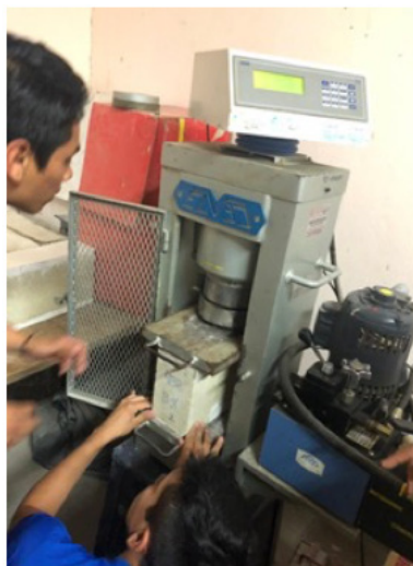
Imagen 1. Prueba a la compresión de bloque de concreto. Fuente: Elaboración propia
