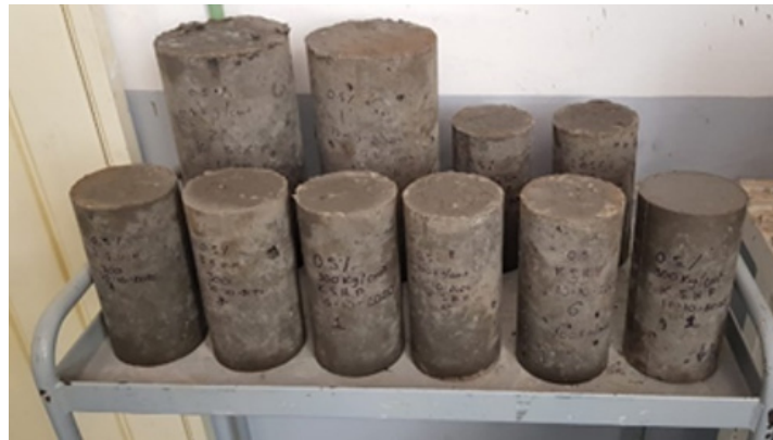
Figura 8. Cilindros con resistencia a la compresión de 24.5 MPa (250 kg/cm 2 ). Fuente: Fotografía tomada en laboratorio
