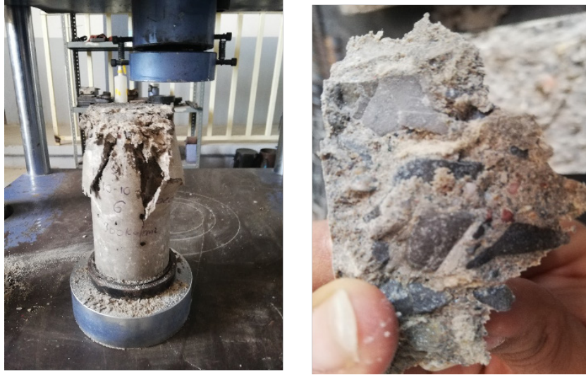
Figura 11. Cilindro sometido a compresión. Fuente: Fotografía tomada en laboratorio
