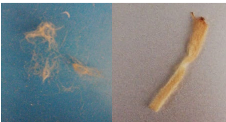
Figura 4. Filamentos obtenidos después de desmenuzar las colillas. Fuente: Fotografía tomada en laboratorio
