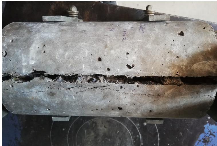
Figura 12. Falla en prueba a la tracción. Fuente: Fotografía tomada en laboratorio
