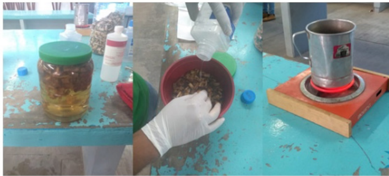
Figura 5. Pruebas de absorción y densidad en colillas. Fuente: Fotografía tomada en laboratorio
