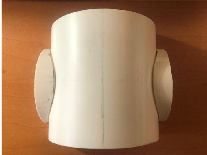
Figura 3. Maqueta de bóveda de cañón con lunetos recortados. Fuente: Elaboración propia
