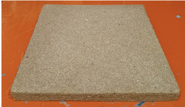
Figura 12. Muestra del panel de aserrín
