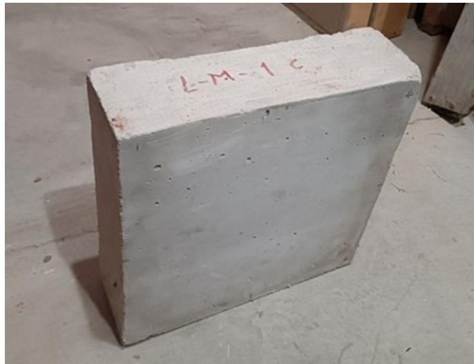
Figura 5. Muestra de losa de concreto armado
