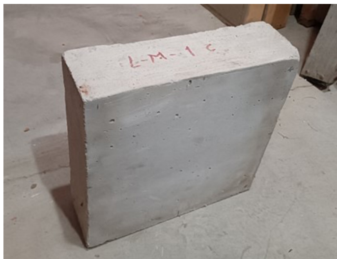
Figura 5. Muestra de losa de concreto armado
