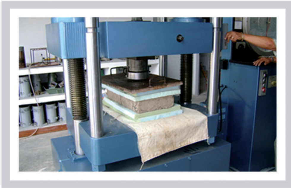
Figura 3. Prueba a compresión de las piezas de adobe de barro (Ovando de la Cruz y Ruíz Castellanos, 2010)
