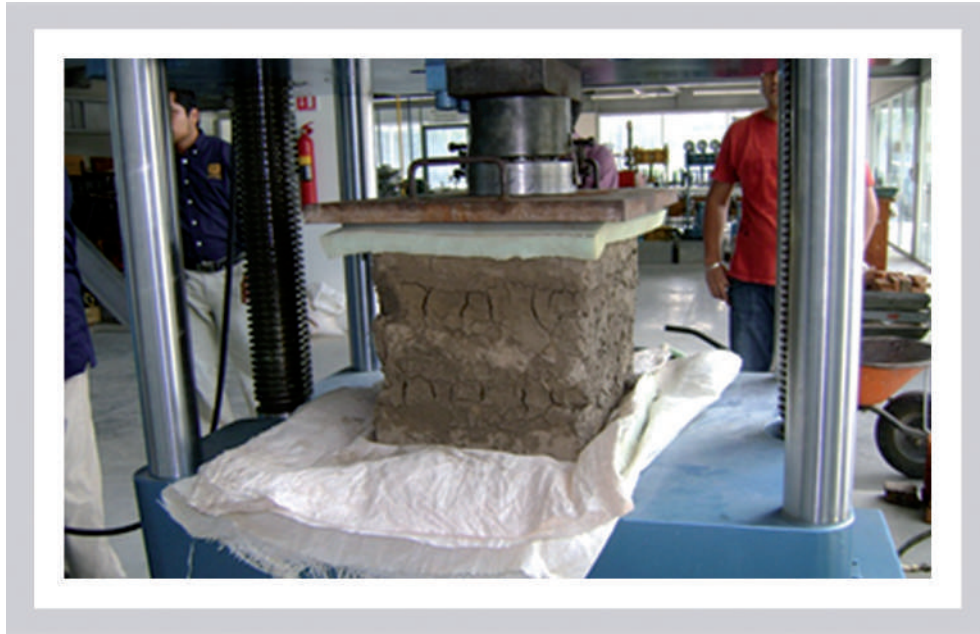
Figura 5. Prueba de compresión de las pilas de adobe de barro (Ovando de la Cruz y Ruíz Castellanos, 2010)
