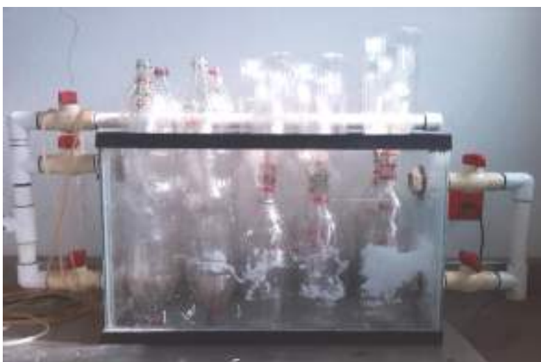
Figura 1. Reactor aerobio con botellas de PET como medio de soporte.
