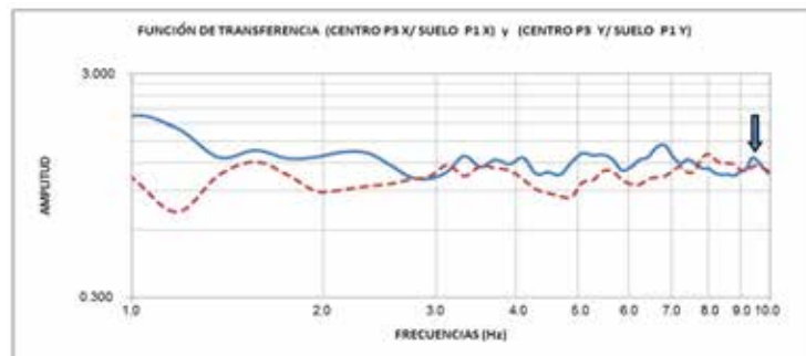
Figura 17. Función de transferencia de la vivienda V2 (Línea continua-X, discontinua-Y).
