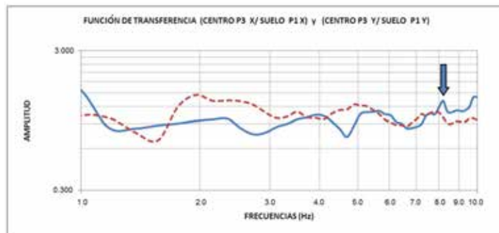
Figura 17. Función de transferencia de la vivienda V2 (Línea continua-X, discontinua-Y).
