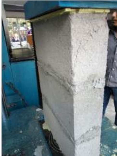
Figura 4. Ensayo de compresión en pila de bloques
