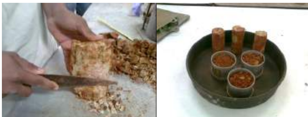
Figura 2. Labrado de especímenes para el ensayo triaxial
