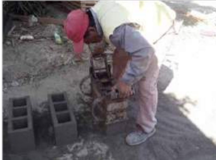
Imagen 17. Proceso de retiro del molde. Fuente: Elaboración propia
