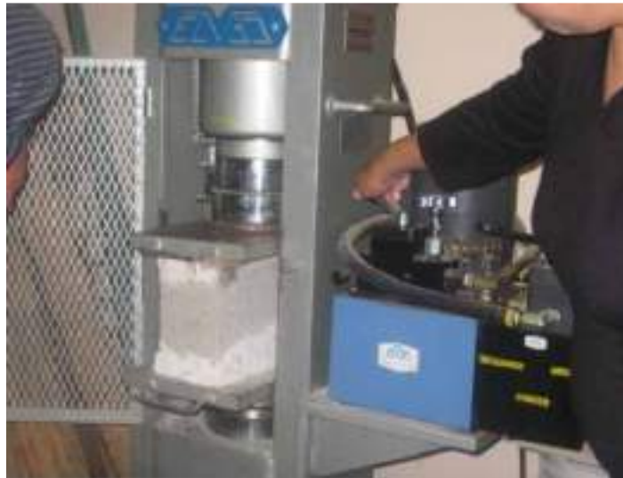
Imagen 14. Prueba de compresión. Fuente: Elaboración propia
