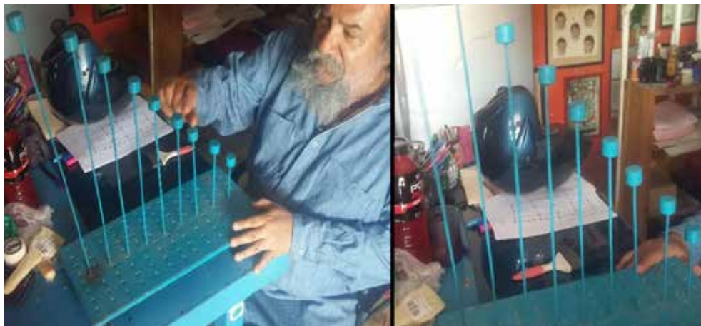
Figura 1. Mesa vibradora basada en excitación humana (diseño y construcción a cargo del M.I. Guillermo Sánchez Trujillo)
