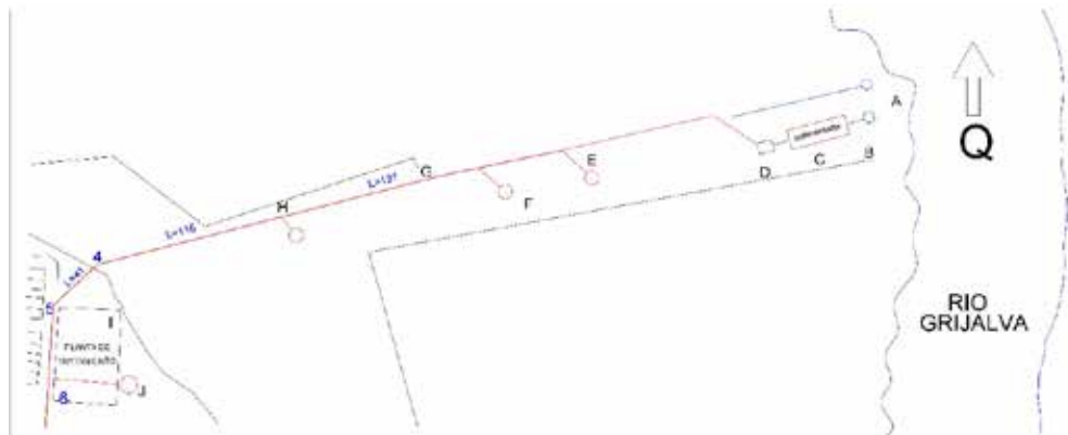
Figura 1. Pozos, cárcamos de bombeo y tanque sedimentador del FJG
