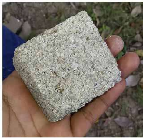
Figura 4. Mortero con 80% de sustitución de arena por vidrio triturado ( Mv_{80}^* ). Fuente: Elaboración propia
