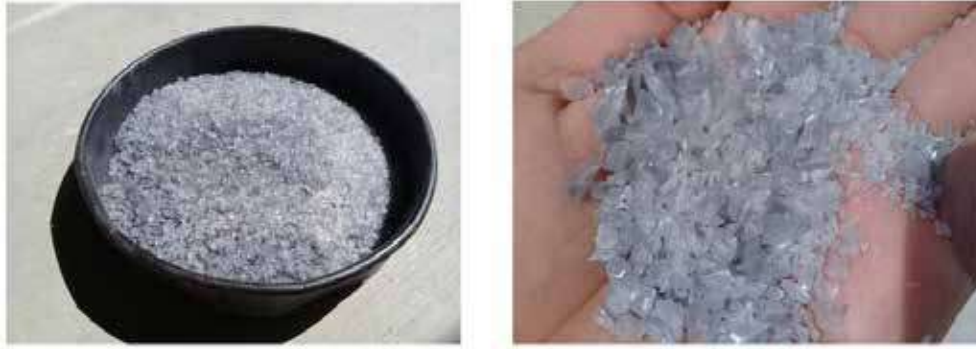
Figura 2. Vidrio triturado usado en las mezclas de mortero. Fuente: Elaboración propia
