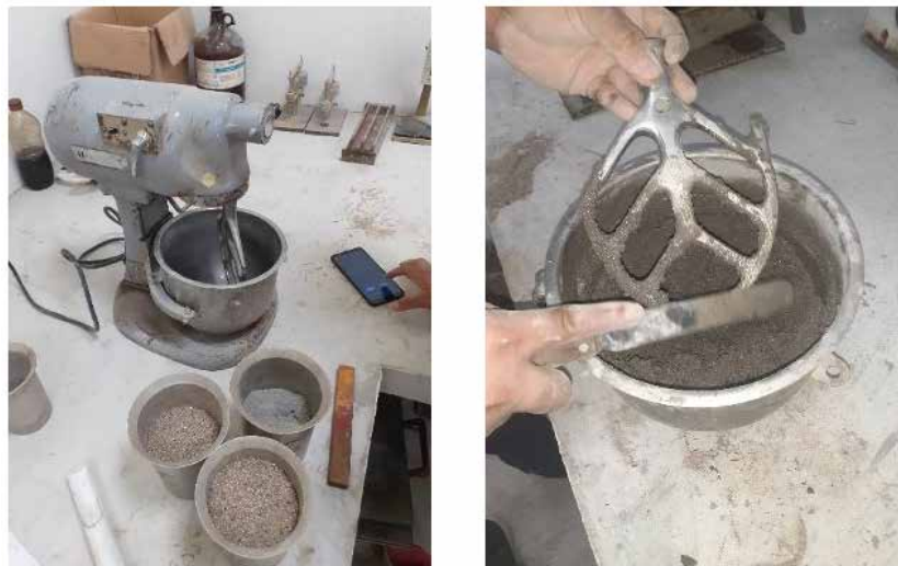
Figura 3. Mezclado del mortero convencional. Fuente: Elaboración propia
