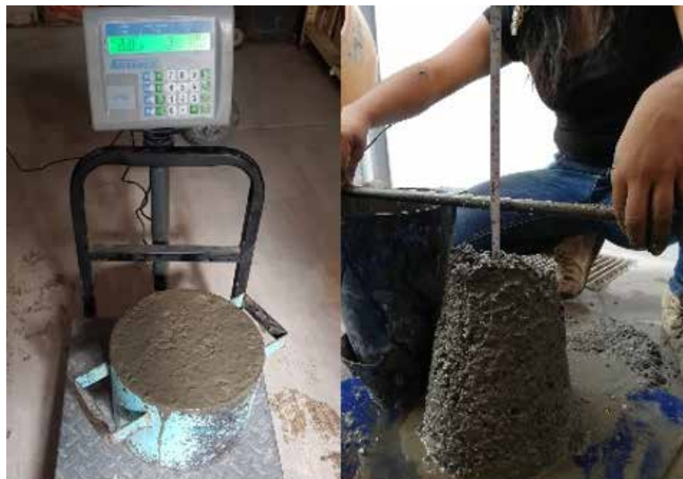
Figura 7. Prueba de densidad y revenimiento al concreto. Fuente: Fotografía tomada en laboratorio
