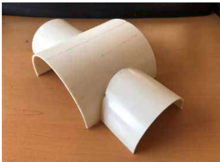
Figura 2. Maqueta de bóveda de cañón con lunetos. Fuente: Elaboración propia
