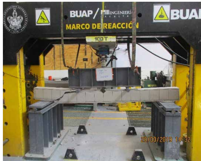
Figura 4. Falla en vigas, colapso por cortante: viga 4. Fuente: Elaboración propia
