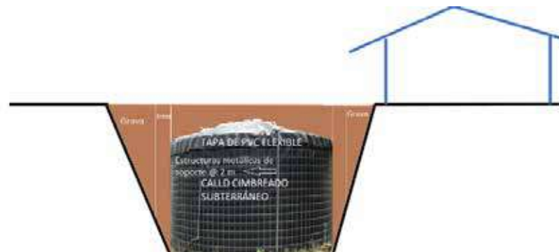
Figura 6. Esquema del CALLD subterráneo, cimbreante de 50,000 litros
