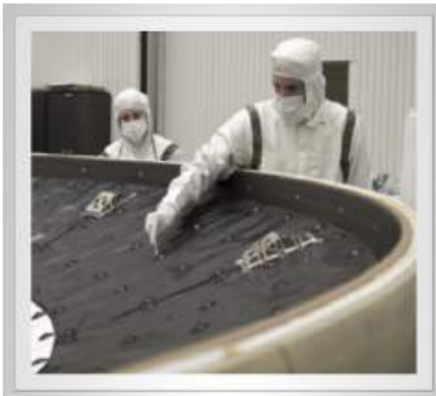
Figura 6: Ingenieros de la NASA examinan el escudo térmico del "Rover Curiosity" y comprueban su limpieza. Foto es cortesía de la NASA [6].
