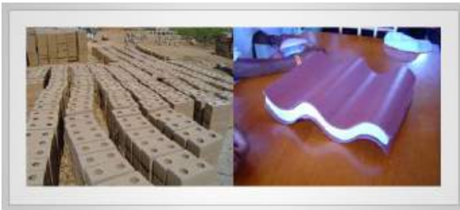
Fig. 5. Material utilizado en muros y techos, bloques de suelo cemento y láminas de fibrocemento con alma de poliestireno expandido de cinco cm. de espesor, con el fin de reducir la ganancia térmica del exterior de la vivienda.
