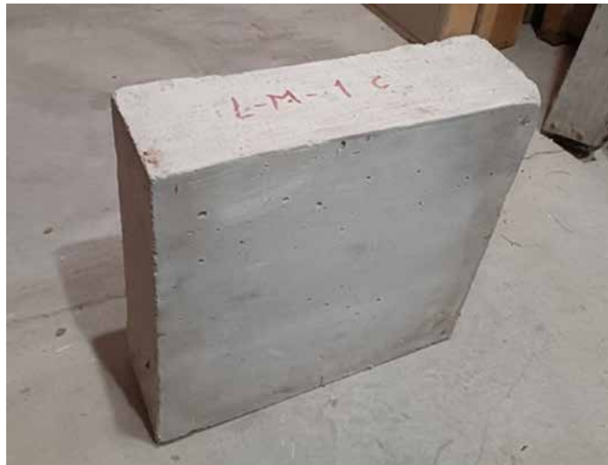
Figura 5. Muestra de losa de concreto armado
