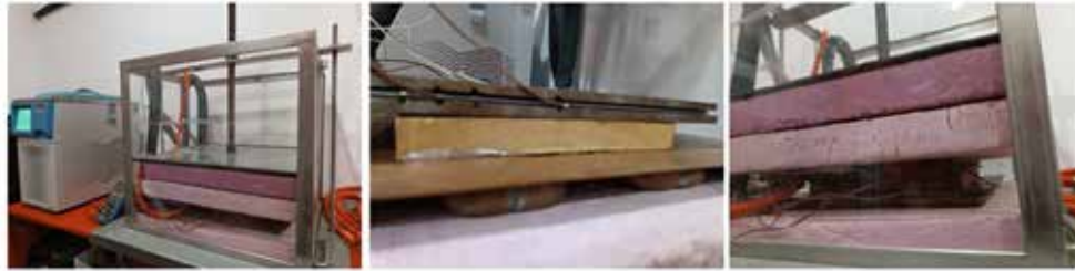
Figura 10. Habilitación del panel de madera en el Equipo de Placa Caliente con Guarda (EPCG)
