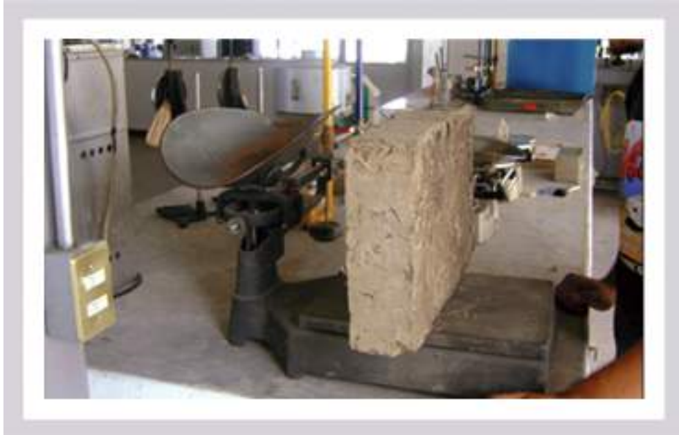
Figura 2. Obtención del peso de cada una de las piezas de adobe ensayadas (Ovando de la Cruz y Ruíz Castellanos, 2010)
