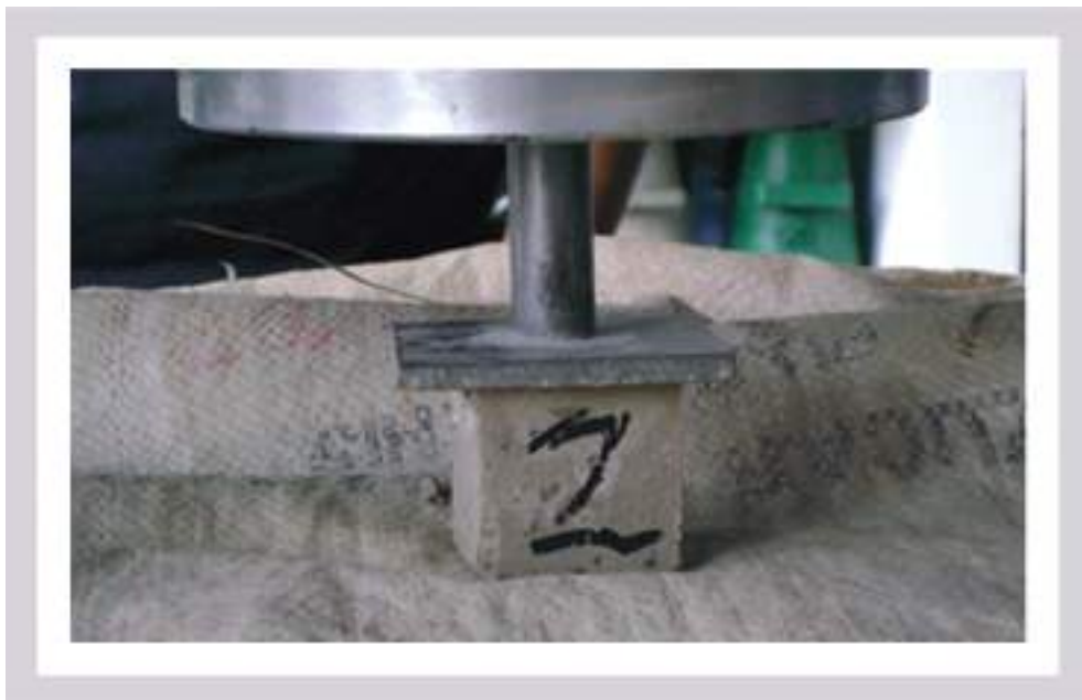
Figura 6. Prueba de compresión de las probetas de mortero de barro (Ovando de la Cruz y Ruíz Castellanos, 2010)
