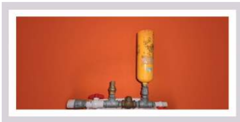
Foto 5. Bomba de ariete hidráulico, Centro de Investigación de la Facultad de Ingeniería
