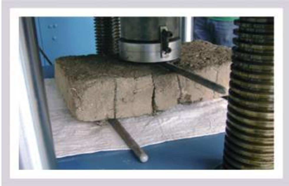
Figure 4. Flexion test on pieces adobe (Ovando de la Cruz y Ruíz Castellanos, 2010)
