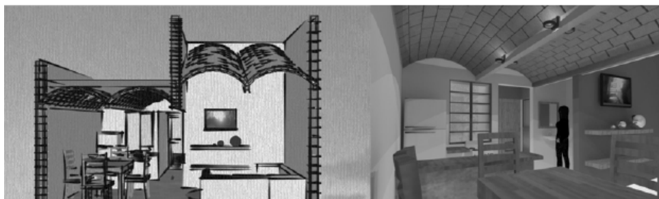
Figura 3 Método constructivo no convencional .Bóveda de cimbra deslizable.
