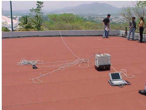
Figura 11 Vista del arreglo del equipo durante el registro de la vibración ambiental
